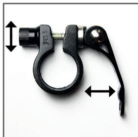
W zależności od modelu zamiast śruby zacisku siedziska instalowane jest szybkozłączce. Jeśli dźwignia nie jest dokręcona lub jest zbyt łatwa do dokręcenia, wyreguluj nakrętkę radełkowaną po lewej stronie, aby szybkozłączce mogło zostać zamknięte przy użyciu siły i zabezpieczyło rurę podsiodłową.
