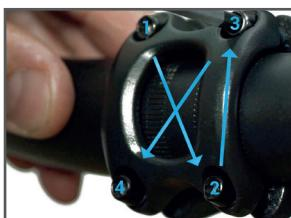
Para montar el manillar en la potencia (1), retire completamente los cuatro tornillos de fijación de la abrazadera de la potencia (3), introduzca el manillar, seleccione la inclinación correcta del mismo y vuelva a apretar con cuidado los cuatro tornillos en cruz. Las medidas de la separación deben ser uniformes, de lo contrario la rosca puede dañarse.
