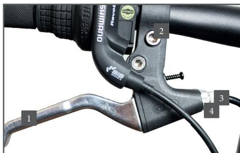
A continuación encontrará la descripción para el montaje del freno de disco y del freno en V, así como las instrucciones para su ajuste. Por regla general, los frenos ya vienen correctamente ajustados de fábrica en el momento de la entrega. Ligeros ruidos chirriantes son completamente normales en las primeras salidas. Ponga el freno (aprox. 30 frenados bruscos) y reajústelo si fuera necesario.
