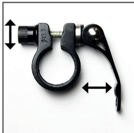
Selon le modèle, un blocage rapide est monté à la place d'un boulon de serrage de la selle. Si le levier ne peut pas être serré, ou s'il est trop facile à serrer, ajustez l'écrou moleté du côté gauche de manière à ce que le blocage rapide puisse être fermé avec force et fixez le tube de selle.
