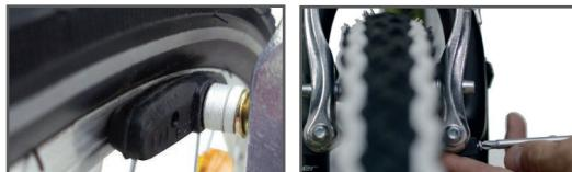
Le frein V-brake est déjà correctement réglé en usine. En cas de frottement ou si la distance entre les deux sabots de frein et la jante n'est pas la même, vérifiez d'abord que les sabots de frein sont correctement alignés avec la jante. Ensuite, la distance peut être équilibrée.
