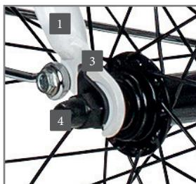
**!** Als het voorwiel niet soepel loopt, controleer dan of het gecentreerd is. Controleer ook of de band (niet de velg) niet de oorzaak is van het probleem. De band zal zich na enkele kilometers instellen en soepel lopen.
