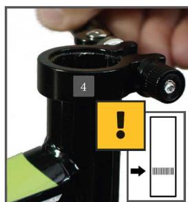
Otwórz blokadę szybkiego zwalniania (4). Wepchnij siodło (1) z sztyką do rury podsiodłowej (5). Ponownie dokręć śrubę zacisku siedziska (alternatywnie zamknij szybkozłączce).
