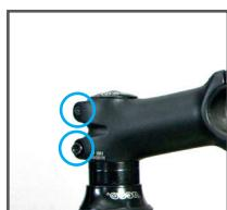
Wysokość kierownicy zwykle nie może być zmieniana na mostku typu A-head. W tym przypadku zmontowany mostek można wymienić na większy lub mniejszy mostek.
