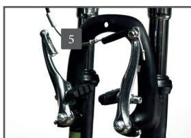
Poluzuj nakrętki osi roweru (4) i przekrój je jak najdalej na zewnątrz. Odczep linkę hamulca (5). Szczęki hamulcowe odchylają się na zewnątrz.
