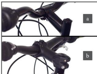
Pour des raisons d'emballage, le guidon a été tourné et démonté. Les composants doivent être réalignés en conséquence en desserrant les vis nécessaires. Les vélos Bergsteiger sont équipés de potences coniques (pages 14 - 15), ainsi que de potences à tête A (pages 16 - 17).
