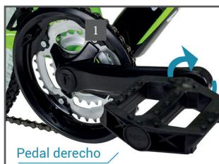
Atornillar el pedal derecho del lado del piñón (1) en la biela en el sentido de las agujas del reloj (como un tornillo convencional).
