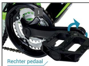
Schroef het rechterpedaal aan de kant van het tandwiel (1) met de klok mee in de crank (zoals een conventionele schroef).
