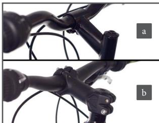
Om verpakkingsredenen werd het stuur verdraaid en gedemonteerd. De componenten moeten dienovereenkomstig worden uitgelijnd door het losdraaien van de nodige schroeven. Voor fietsen van bergbeklimmers worden zowel conische voorbouwen (blz. 14 - 15) als aheadvoorbouwen (blz. 16 - 17) gebruikt.
