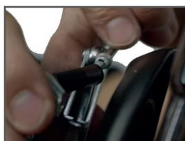
Po założeniu koła przedniego należy przymocować linkę hamulca. Aby to zrobić, naciśnij dwa ramiona hamulca (3) razem i umieść rurkę prowadzącą (7) w przewidzianym rowku (jak na rysunku). Jeśli nie jest to możliwe nawet przy dużym wysiłku, można nieco poluzować nakrętkę (2), a tym samym wydłużyć linkę hamulca (ponownie dokręć nakrętkę mocującą (4)).
