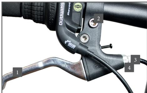
Hieronder vindt u beschrijvingen van de constructie van de schijfrem en de V-rem en instructies voor het afstellen ervan. In de regel zijn de remmen bij levering in de fabriek al correct afgesteld. Lichte slijpgeluiden zijn volkomen normaal bij de eerste ritten. Trek de rem in (ca. 30 keer hard remmen) en stel de rem zo nodig bij.
