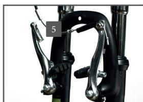
Aflojar las tuercas del eje exterior (4) y girarlas hacia fuera lo máximo posible. Desenganchar el cable de freno (5). Las zapatas de freno giran hacia afuera.
