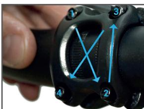
Om het stuur aan de voorbouw (1) te monteren, de vier klem-schroeven van de voorbouwklem (3) volledig verwijderen, het stuur inbrengen, de juiste helling van het stuur kiezen en de vier schroeven weer voorzichtig kruislings vastdraaien. De spleetafmetingen moeten gelijkmatig zijn, anders kan de schroefdraad beschadigd raken.
