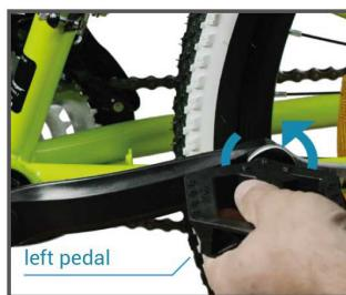
**!** Avant chaque trajet, vérifiez que les pédales sont bien en place. Resserrer les pédales, en particulier après les premiers kilomètres ! Des pédales desserrées peuvent entraîner des blessures et endommager le filetage de la pédale. Les dommages causés par une installation incorrecte ne sont pas couverts par la garantie.
