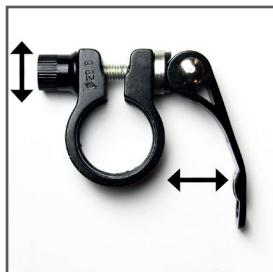
Dependiendo del modelo, puede venir instalado un cierre rápido en lugar de un tornillo de sujeción del sillín. Si la palanca no puede apretarse o resulta demasiado fácil de apretar, ajuste la tuerca moleteada del lado izquierdo para que el cierre rápido pueda echarse con fuerza y se asegure el tubo del asiento.
