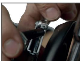
Na het inbrengen van het voorwiel moet de remkabel worden ingehaakt. Druk hiervoor de twee remarmen (3) tegen elkaar en plaats de geleidebus (7) in de daarvoor bestemde groef (zoals afgebeeld). Als dit zelfs onder grote inspanning niet mogelijk is, kunt u de verankерingsmoer (2) iets losser maken en zo de remkabeltrek verlengen (verankeringsschroef (4) weer vastdraaien).
