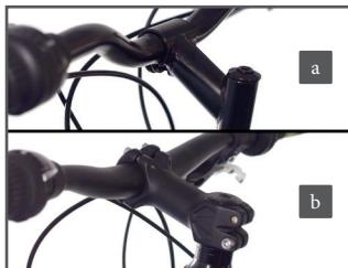
Ze względu na opakowanie kierownica została skręcona i zdemontowana. Elementy należy odpowiednio wyrównać poprzez poluzowanie niezbędnych śrub. W rowerach Bergsteiger są zamontowane zarówno mostki klasyczne (wpuszczane) (strony 14–15) jak i mostki typu A-head (strony 16–17).
