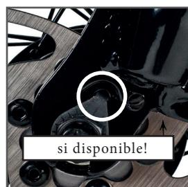
Desserrez les deux écrous d'essieu extérieurs (2). Pousser la roue avant dans la fourche (1).
