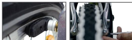
El freno en V ya viene correctamente ajustado de fábrica. Si todavía rechina o la distancia entre las dos zapatas de freno y la llanta no es la misma, asegúrese primero de que las zapatas estén correctamente alineadas con la llanta. Después ya puede equilibrarse la distancia.
