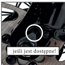
Poluzuj dwie nakrętki osi roweru (2). Wepchnij przednie koło do widełka (1).
