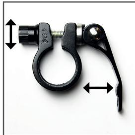
Afhankelijk van het model wordt een snelsluiting gemonteerd in plaats van een zadelklembout. Als de hendel niet of te gemakkelijk kan worden aangedraaid, stel dan de kartelmoer aan de linkerkant af, zodat het snelspanslot met kracht kan worden gesloten en de zadelbuis kan worden vastgezet.
