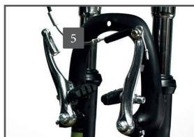
Desserrer les écrous d'essieu extérieurs (4) et les tourner le plus possible vers l'extérieur. Décrocher le câble de frein (5). Les mâchoires de frein pivotent vers l'extérieur.
