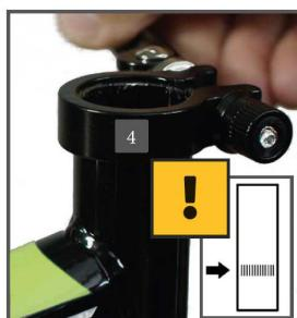
Ouvrez l'attache rapide (4). Poussez la selle (1) avec la potence de selle dans le tube de selle (5). Resserrez la vis du collier de serrage de la selle (ou bien fermez la fermeture rapide).
