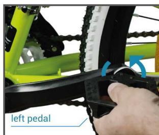
**!** Controleer voor elke rit of de pedalen goed vastzitten. Vooral na de eerste kilometers moet u de pedalen weer aanhalen! Losse pedalen kunnen leiden tot letsel en beschadiging van de pedaaldraad. Schade veroorzaakt door onjuiste installatie is uitgesloten van elke garantie.
