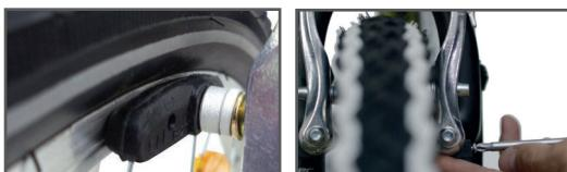
De V-rem is van in de fabriek al correct afgesteld. Als ze nog steeds sleep of als de afstand tussen de twee rem schoenen en de velg niet gelijk is, controleer dan eerst of de rem schoenen correct zijn uitgelijnd met de velg. Dan kan de afstand worden bijgeregd.
