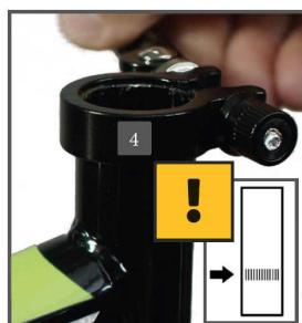
Abrir el cierre rápido (4). Introduzca el sillín (1) con la barra de sillín en el tubo del asiento (5). Vuelva a apretar el tornillo de sujeción del sillín (de forma alternativa, echar el cierre rápido).
