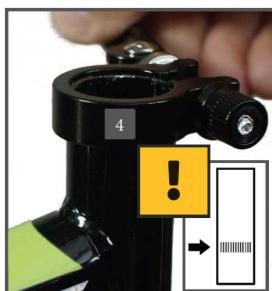
Open de snelsluiting (4). Duw het zadel (1) met de zadelpen in de zadelbuis (5). Draai de zadelklemschroef weer vast (of sluit de snelsluiting).
