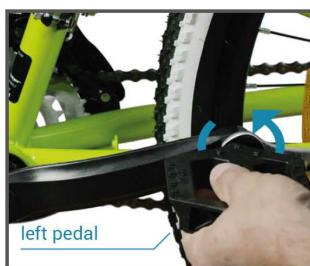
**!** Antes de cada recorrido, compruebe que los pedales estén bien asentados. Sobre todo después de los primeros kilómetros hay que reapretar los pedales. Los pedales sueltos pueden causar lesiones y dañar la rosca del pedal. Los daños causados por un montaje incorrecto están excluidos de cualquier garantía.
