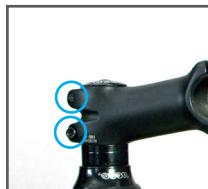
La hauteur du guidon ne peut généralement pas être modifiée sur une potence en tête de fourche. Dans ce cas, le montage La potence peut être remplacée par une potence plus grande / plus petite.
