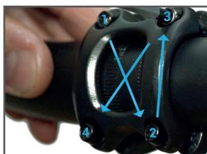
Aby zamontować kierownicę na mostku(1), należy całkowicie odkręcić cztery śruby zaciskające zacisk mostka (3), włożyć kierownicę, wybierz prawidłowe nachylenie kierownicy i ostrożnie dokręcić cztery śruby na krzyż. Wymiary szczeliny muszą być równe, w przeciwnym razie gwint może zostać uszkodzony.
