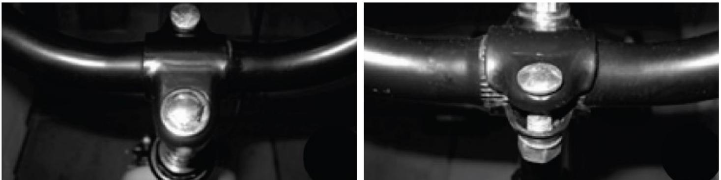
Durch lösen der Lenkkopfschraube (Bild 1) kann die Höhe und der Winkel des Lenkers eingestellt werden. Wenn Sie die Klemmschraube (Bild 2) lösen, haben Sie die Möglichkeit, die Neigung des Lenkers auf die Bedürfnisse des Kindes einzustellen.
