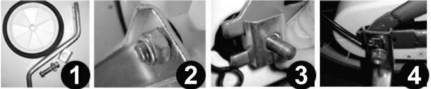
Nehmen Sie die lange Schraube und schieben Sie diese durch den Reifen. Stülpen Sie die Unterlegscheibe darüber, dann das Halteeisen des Stützrades und schrauben Sie alles mit der Mutter fest (Bild 2). Verfahren Sie mit dem anderen Stützrad genauso. Entfernen Sie nun die Hutmuttern an der Achse des Hinterrades. Stecken Sie die Metallarretierung auf die Achse (Bild 3). Nun können Sie das Stützrad mit der Achsmutter wieder festziehen. **Die Stützräder sollten fest auf der Achse sitzen.**
