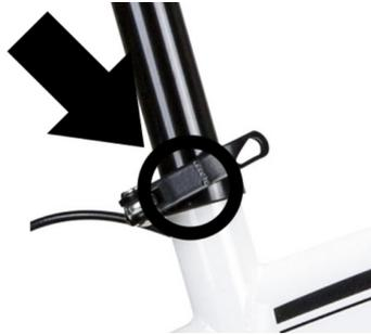
**Sattel:** Lösen sie den Schnellspanner am Rahemnrohr, setzen Sie die Sattelstange ein und schließen Sie den Schnellspanner wieder.
