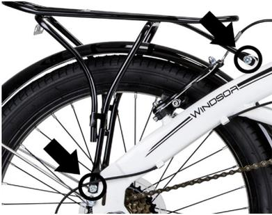
**Gepäckträger:** Lösen sie die markierten vier Schrauben im Rahmen des Rades, setzen Sie den Gepäckträger an den Rahmen und verschrauben Sie diesen wieder.
