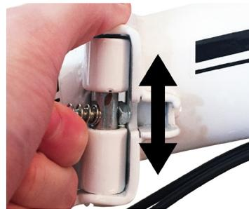
Den Schnellspanner nach oben und ziehen und gleichzeitig den Rahmen auseinanderklappen. Beim späteren Zusammenklappen sollte immer ein Klickgeräusch zu hören sein. Dieses Geräusch signalisiert, dass der Rahmen korrekt eingerastet ist.
