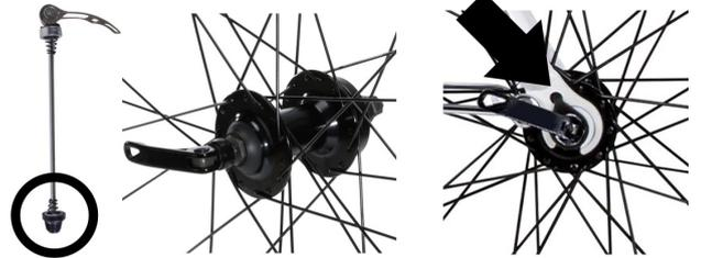
**Vorderrad:** Schieben Sie die Schnellspannachse durch die Nabe des Vorderrades und setzen Sie das Vorderrad in die Gabel ein. Hängen Sie vorher gegebenenfalls die Bremse aus. Setzen Sie die Haltenase in das Loch der Gabel (letztes Bild) und schließen Sie den Schnellspanner. Hängen Sie danach die Bremse wieder ein.
