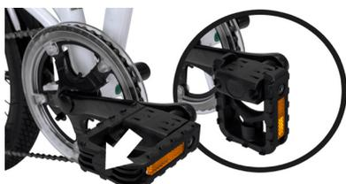
3. Klappen Sie die Pedale zum Auseinanderklappen lediglich bis zu einem deutlichen Klickgeräusch nach oben. Zum Zusammenklappen ziehen Sie die Pedale nach außen und klappen Sie diese herunter.
