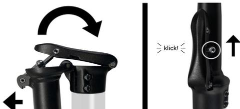
2. Klappen Sie den Lenker um und fixieren Sie ihn mithilfe des Klapphebels. Sobald Sie das Klickgeräusch hören, ist der Vorbau eingerastet. Um den Lenker wieder umzuklappen, schieben Sie die Verriegelung nach oben und öffnen Sie den Klapphebel.
